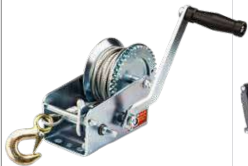
BWR5190 Εργάτης χειροκίνητος • Μέγιστο φορτίο 900Kg • Σύρμα Ø5mmx10m
